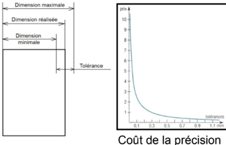
2/ **Nécessité des tolérances** : Les procédés d'usinage font qu'une pièce ne peut être réalisée de façon rigoureusement conforme aux dimensions fixées. Il a donc fallu tolérer que la dimension réalisée soit comprise entre deux dimensions limites, compatibles avec un fonctionnement correct de la pièce. La différence entre ces deux dimensions constitue la tolérance.
